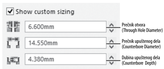
Slika 7-6 Parametri za ravno upušten otvor prikazani potvrđivanjem opcije Show custom sizing
