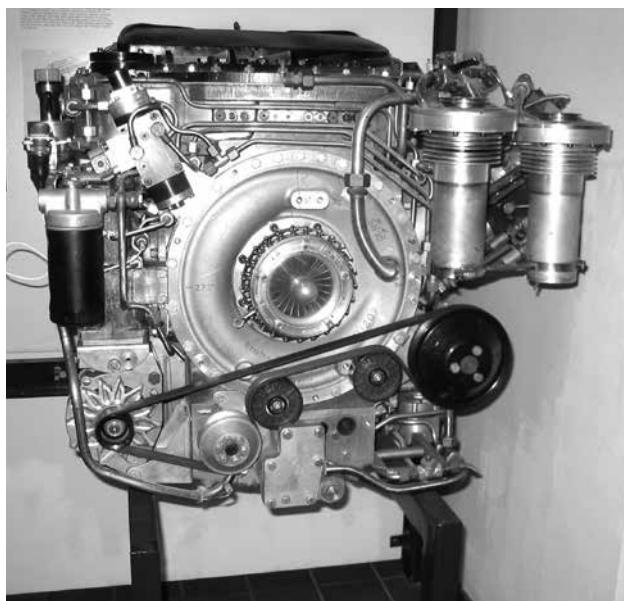
Eksperimentalna gasna turbina Daimler Benz PWT 110 iz 1984. godine, namenjena pogonu putničkog automobila. Snaga je bila 110 kW pri čemu je radno kolo dostizalo 55.000 o/min. Projekat nije zaživeo.
