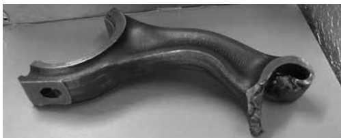
Slika 2-3. Inicijalna pukotina u okcima klipa i povećanje zazora osovinice čuli su se kao kucanje. Motor nije odmah zaustavljen, klip se potpuno polomio i na kraju je oslobođena klipnjača probila blok motora
