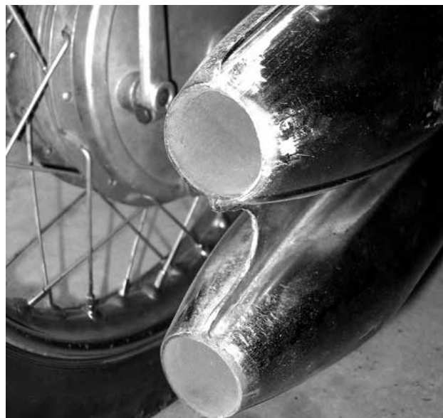
Slika 2-13. Talog na izduvnoj cevi koji potiče od primene olovnog benzina – takođe znak dobrog stanja motora i potpunog sagorevanja.
