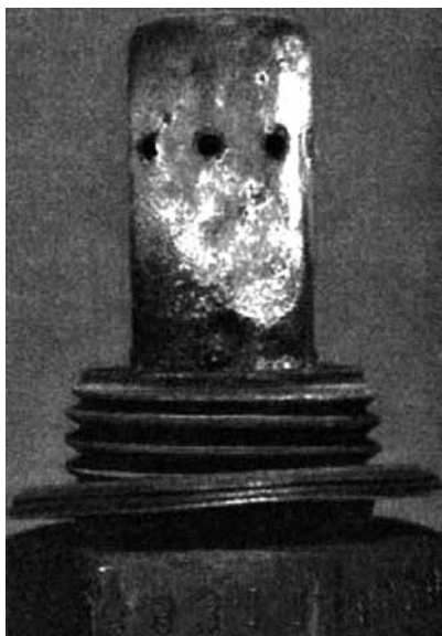
Slika 2-12. Sjajne naslage na sondi znak su prisustva olova na senzoru, zbog upotrebe olovnog benzina. Olovo oštećuje materijale od kojih su napravljeni senzor i katalizator ( Magneti Marelli ).
