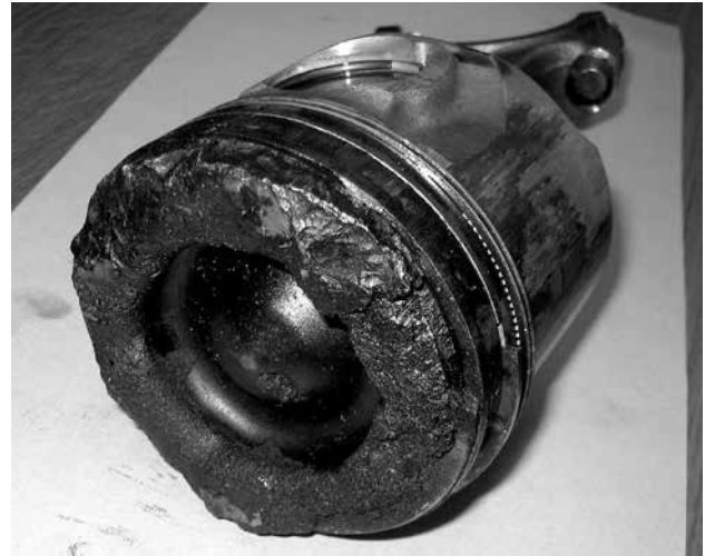
Slika 2-10. Klip common-rail dizel motora oštećen nepravilnim sagorevanjem.
