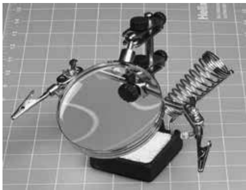
Slika 12-4. Ova verzija „treće ruke“ sadrži žičanu spiralu u koju možete umetnuti lemilicu, sunder za čišćenje vrha i veliku lupu.
