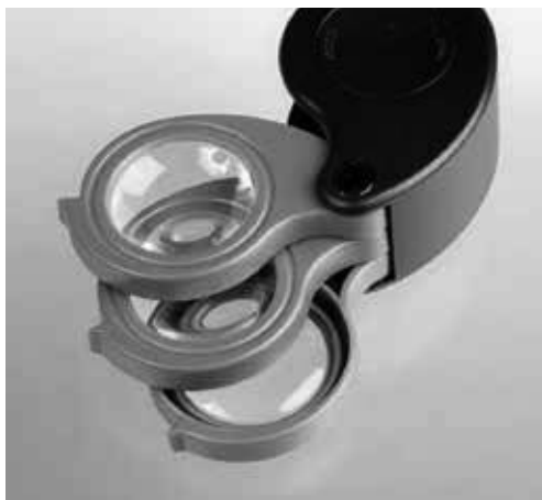
Slika 12-10. Ova tri sočiva su identična, ali ako spojite dva ili tri, ukupno uvećanje se umnožava.
