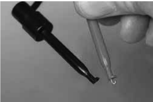
Slika 12-20. Merni kablovi koji se završavaju „mini hvataljkama“.
