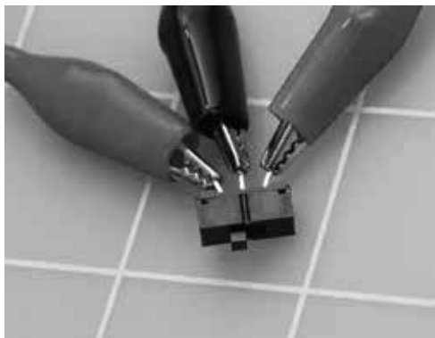
Slika 6-30. Razmaknite izvode malog prekidača da biste mogli da zakačite krokodilke testnih kablova.
