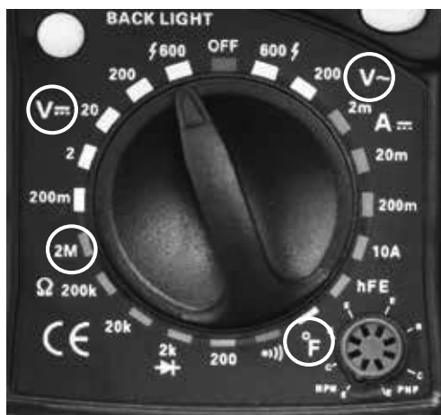
Slika 1-7. Pregledom birača ovog instrumenta vidimo da nedostaju neke poželjne karakteristike.
