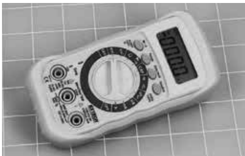
Slika 1-2. Instrument sa automatskim podešavanjem opsega.
