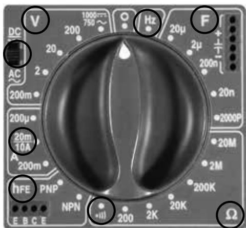
Slika 1-6. Birač instrumenta koji može da obavlja sva merenja poželjna u ovoj knjizi.
