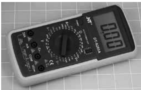
Slika 1-3. Instrument sa ručnim podešavanjem opsega.
