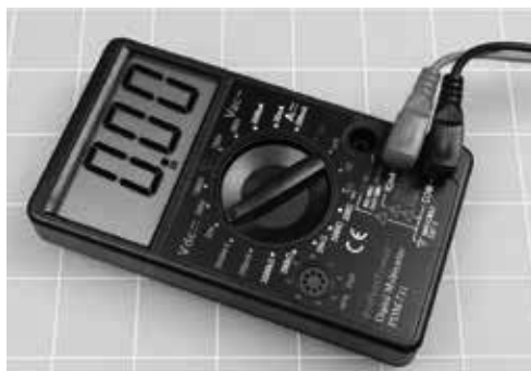
Slika 1-1. Najprostiji digitalni multimetar. Kvadrati na podlozi su stranice od 2,5 cm.
