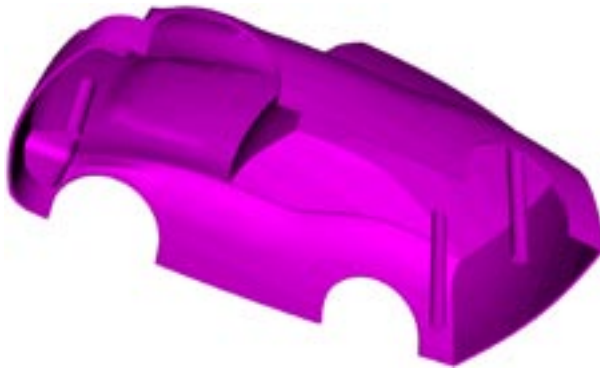
Slika 1-26 Prikaz odozgo punog modela automobilske školjke konstruisanog od skupa povezanih površina
