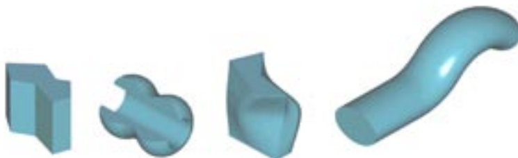
Slika 1-9 Realističan prikaz izvučenog tela, obrtnog tela, tela izvučenog metodom loft i tela izvučenog metodom sweep
