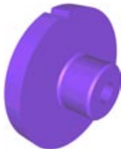
Slika 1-10 Izvučeno puno telo (zubac) usečeno u obrtno puno telo (telo zupčanika)
