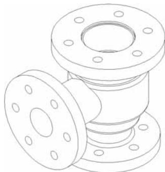
Slika U-20 Kućište za spajanje cevi
