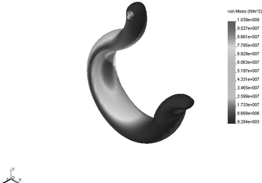
Slika U-24 Kuka dizalice analizirana pomoću alatke COSMOSXpress
