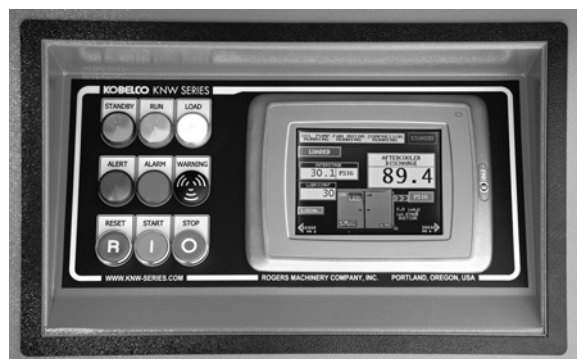
Slika 1-26 Operatorski interfejs za PLC i monitor.
