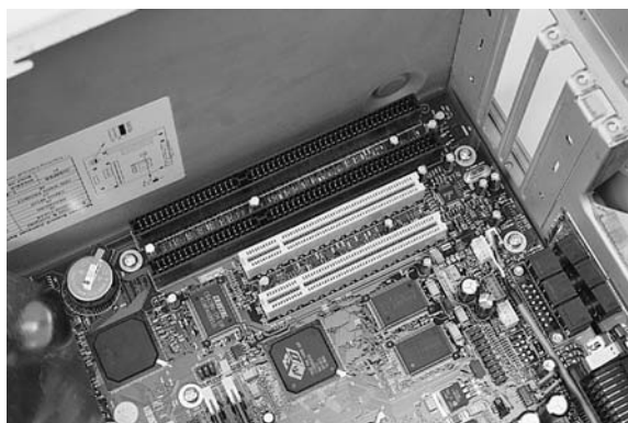
Slika 2.14: Priključci za PCI i ISA magistrale.
