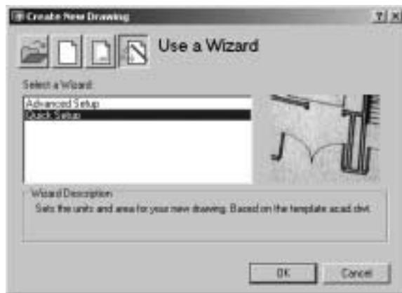
4. Izaberite opciju Quick Setup, a zatim pritisnite OK. Pojavljuje se okvir za dijalog Quick Setup Units.
